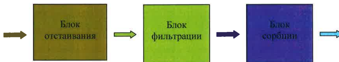
Рисунок 1 – Принципиальная технологическая схема установок для очистки поверхностных стоков
