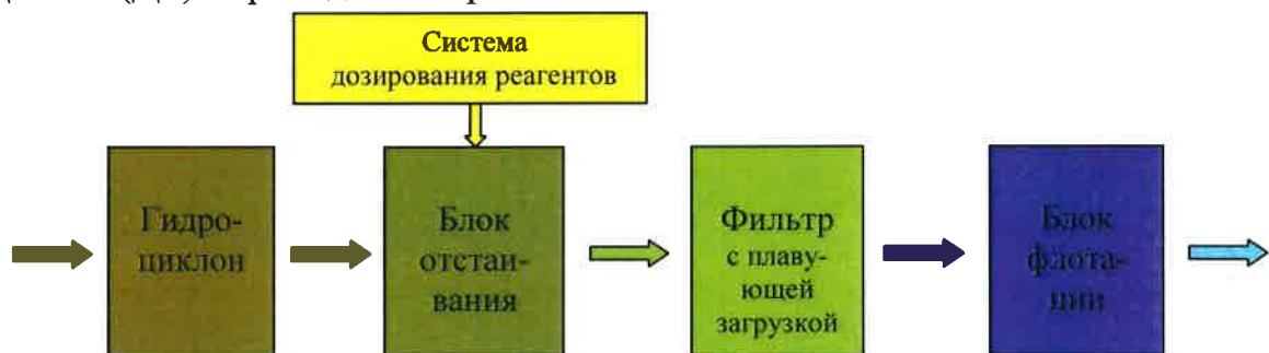
Рисунок 8 – Принципиальная технологическая схема установки серии «МОЙДОДЫР-М(ДР)»
