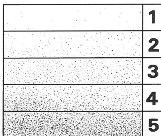
Рисунок 1 - Изобразительные ссылки, соответствующие значениям количества пыли в соответствии с ISO 8502:3 (Figure 1)
