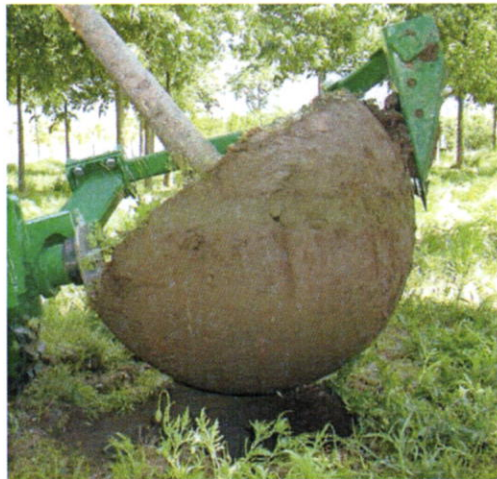
Рисунок 1 – Выкапывание дерева с комом земли
