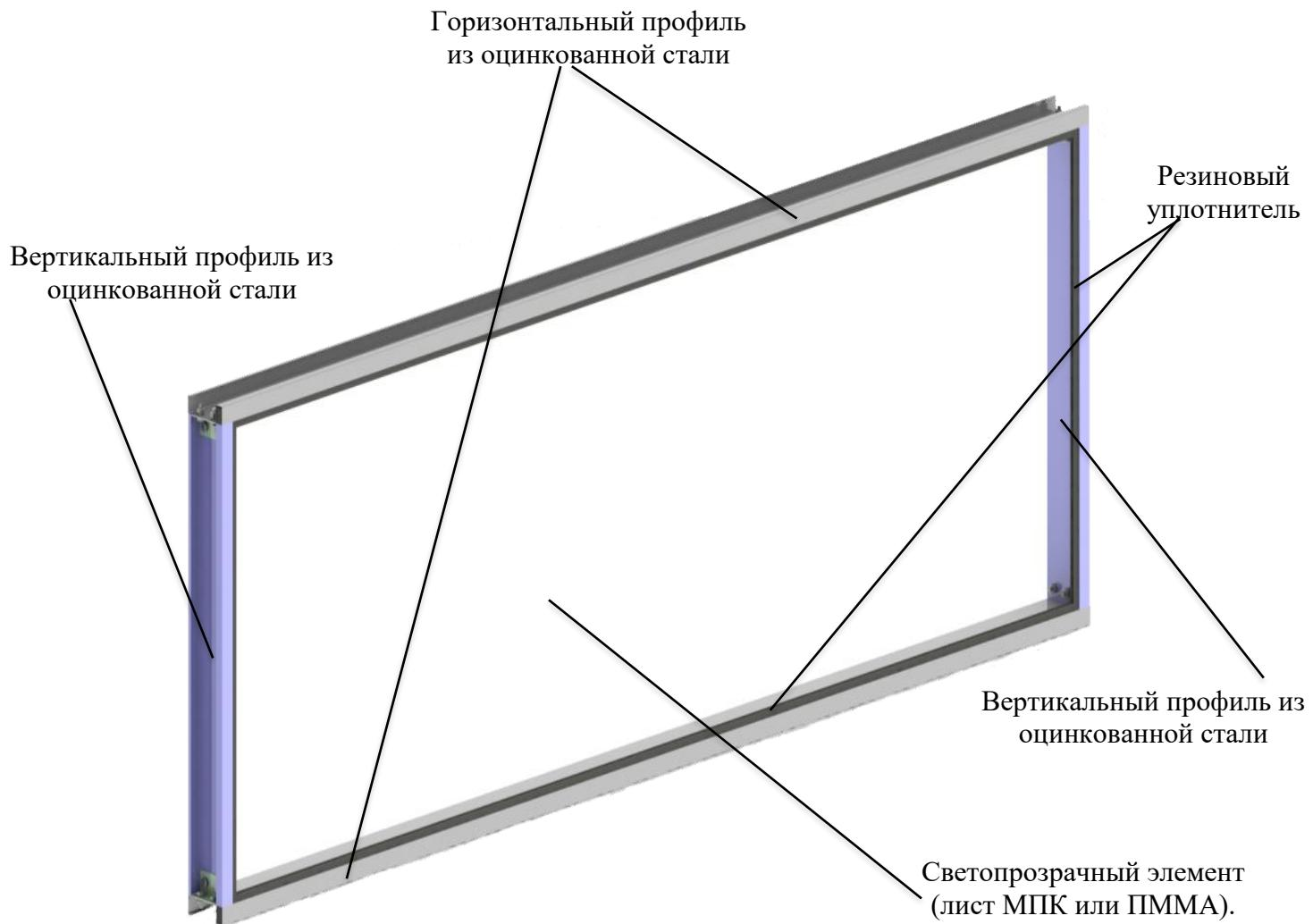
Рисунок 1 - Конструкция светопрозрачной панели.
