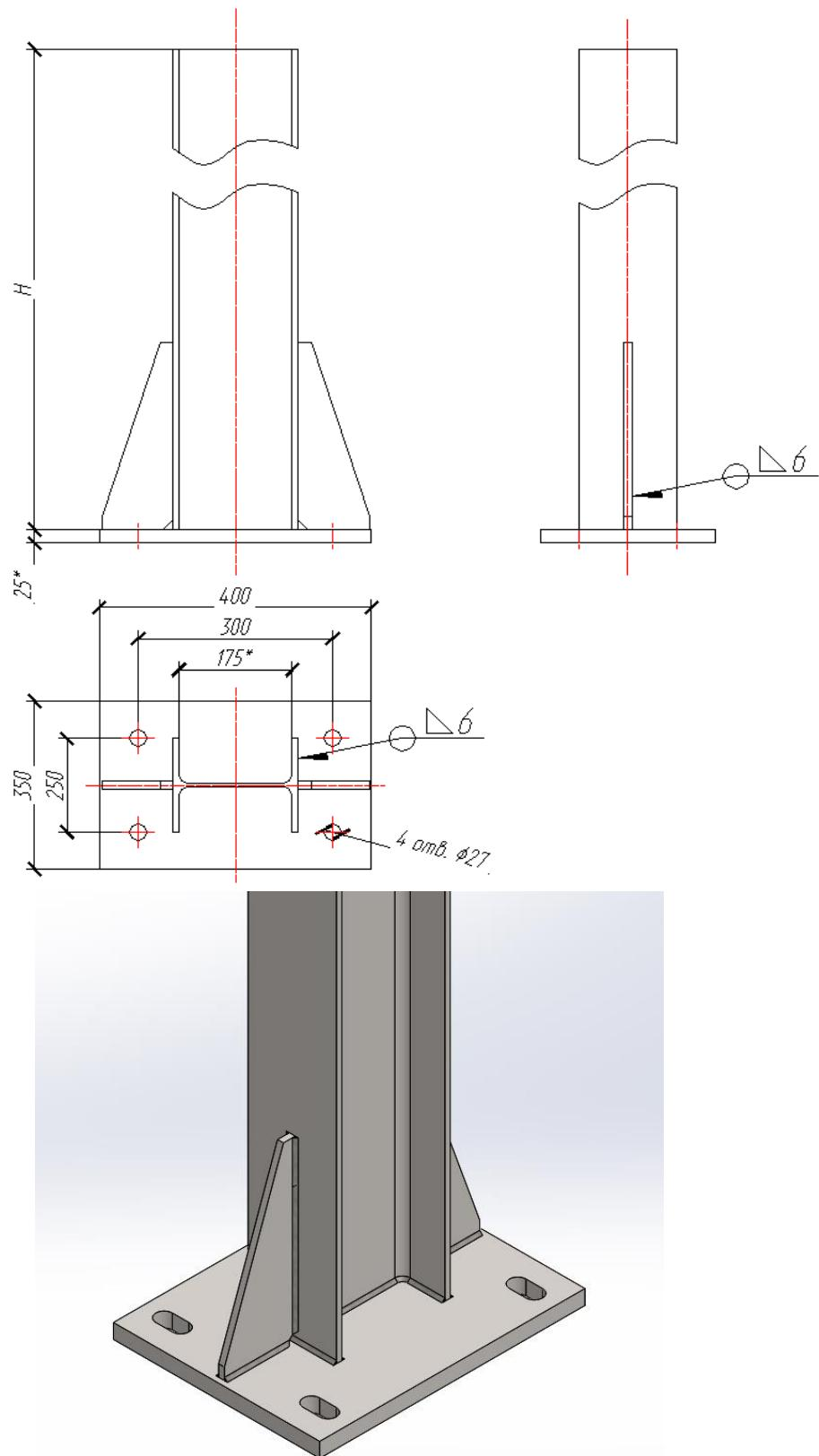
Рисунок Б.1 - Конструкция стойки щумозащитного экрана.
