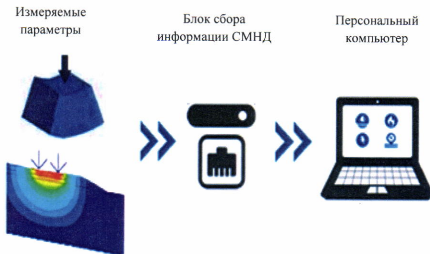
Рисунок 3 – Схема работы СМНД
