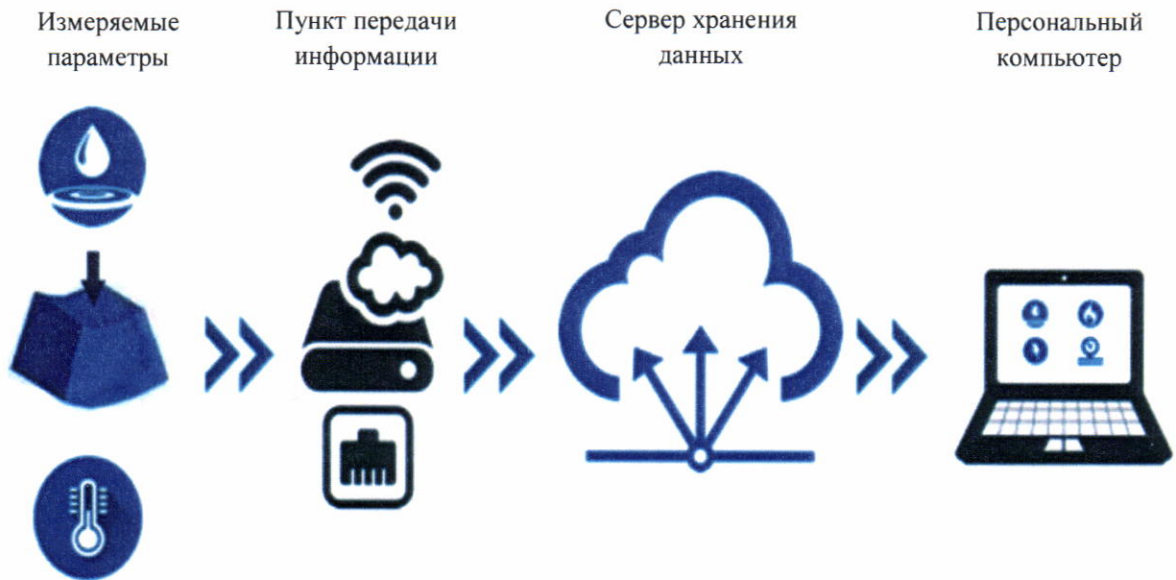
Рисунок 2 – Схема работы наблюдательной станции
