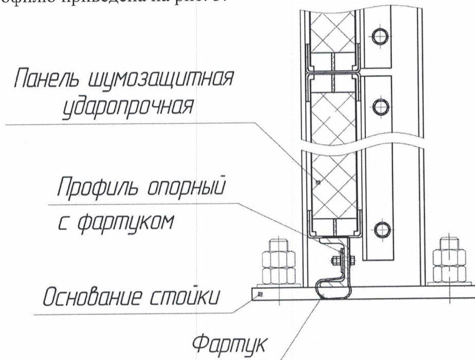
Рисунок 3 - Схема крепления фартука к опорному профилю
