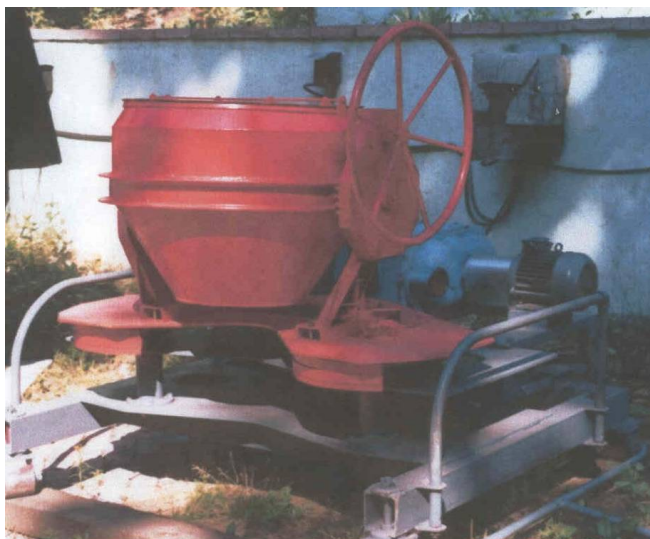
Рис 4. Мобильный капсулятор-смеситель КЦ – 2 для ремонтных работ по крупнопористому дренажному бетону КАПСИМЭТ на трассах
