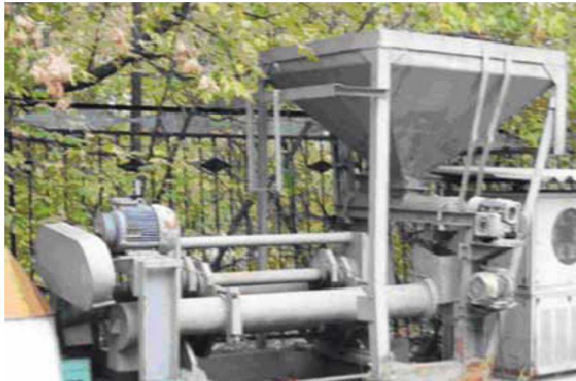
Рис 1. Капсулятор-смеситель с рабочими камерами ГРК производительностью 5 м 3 в час для капсуляции крупных заполнителей
