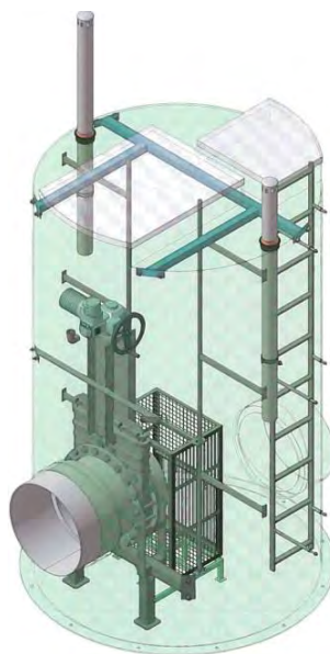
Рис.26. Колодец с сороудерживающей корзиной и шиберным затвором
