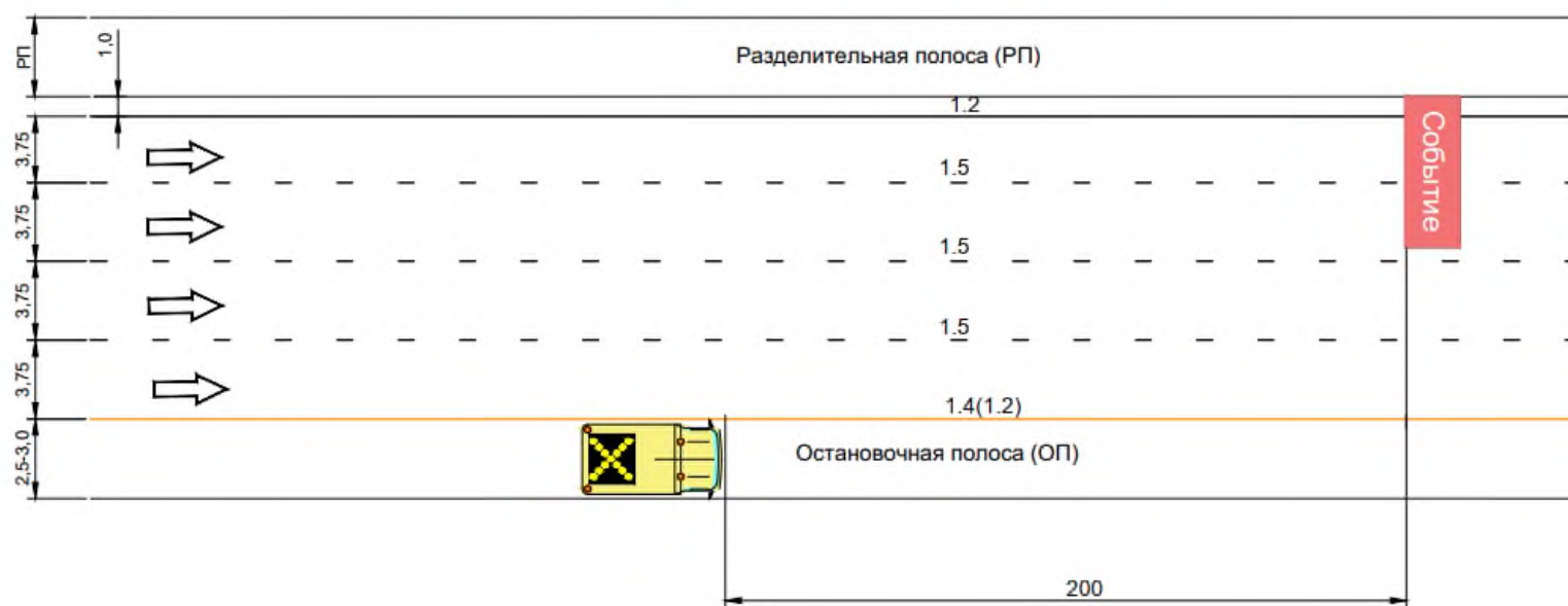
АМ008: План расстановки ТСОДД при осуществлении аварийных мероприятий в условиях ограниченной / недостаточной видимости.
