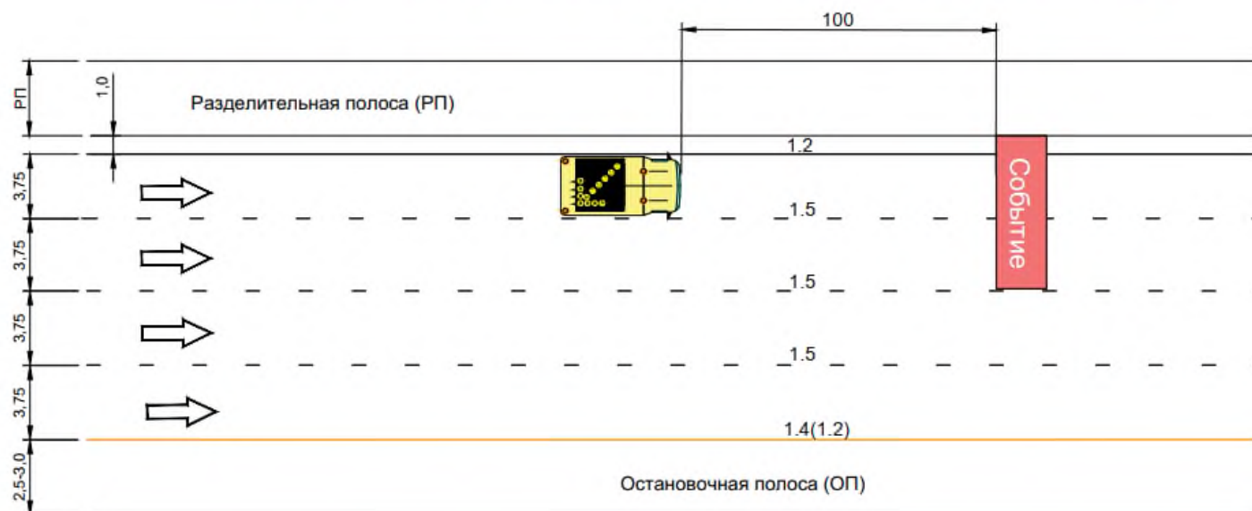
АМ004: План расстановки ТСОДД при осуществлении аварийных мероприятий на средней и крайней левой полосах.
